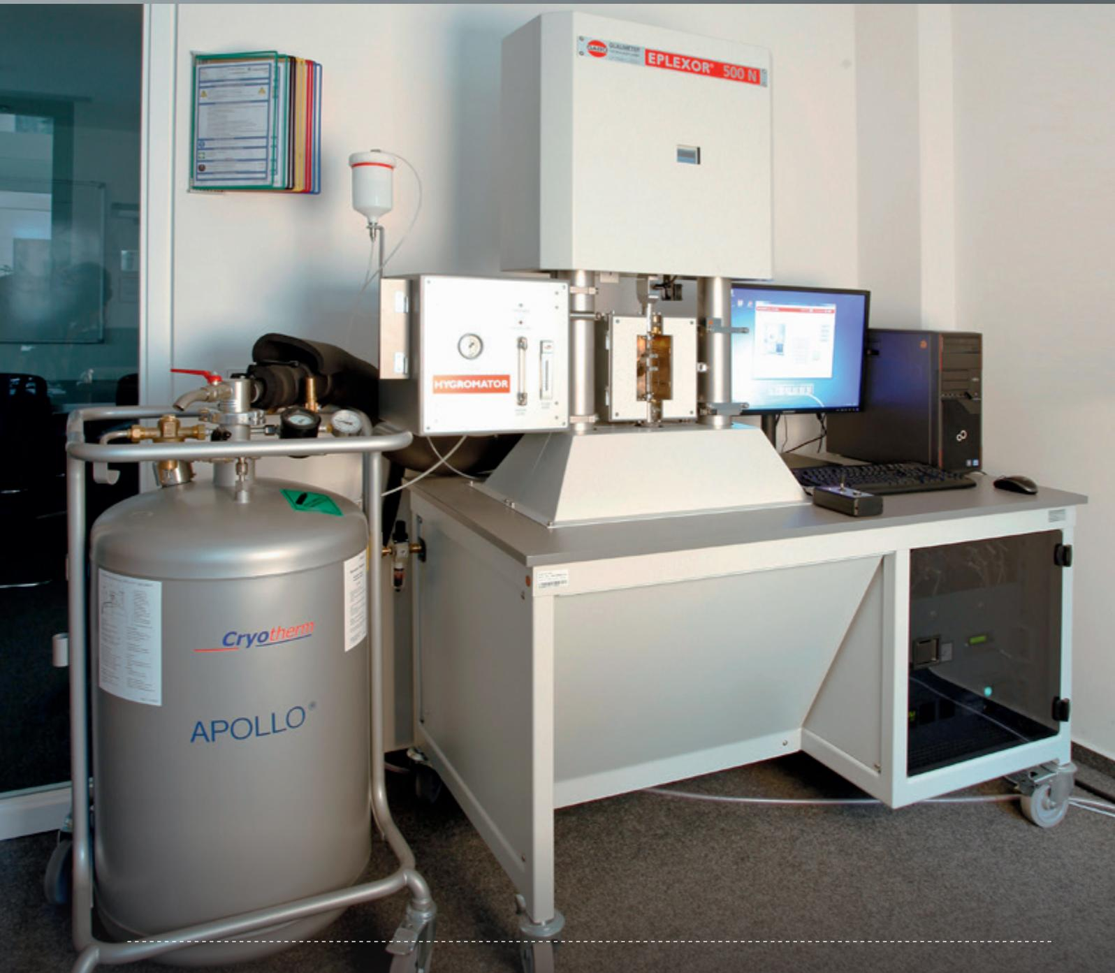
Gerät zur dynamisch-mechanischen Thermo-Analyse (DMTA) für die präzise inhouse Charakterisierung von Materialparametern, die für die Mikrostruktursimulation von porösen Medien und Verbundwerkstoffen benötigt werden. Mithilfe der Stickstoffkühlung und des Hygromators können Messungen in einem großen Temperatur- und Feuchtebereich durchgeführt werden. Schließlich dient das Gerät zur Validierung von Simulationsergebnissen.
